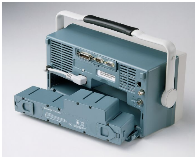
Батарея TDS3BATC обеспечивает до 3 часов автономной работы осциллографа.
